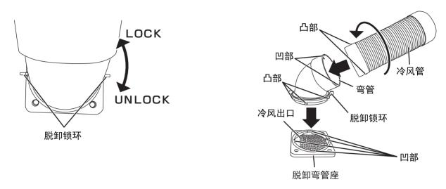
●排热管座和排热管的安装方法 将排热管座用4只自攻螺钉固定在排热口上,排热管向下套入排热管座上即可。
